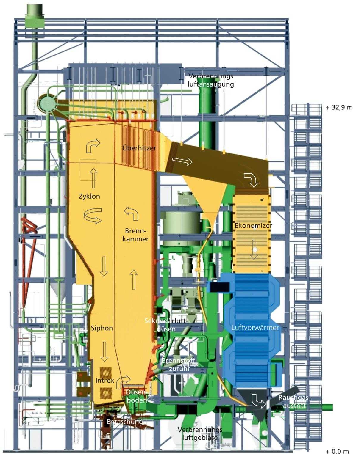
Der Kessel des Biomasseheizkraftwerks Emlichheim ist mit einer zirkulierenden Wirbelschichtfeuerung ausgerüstet.
