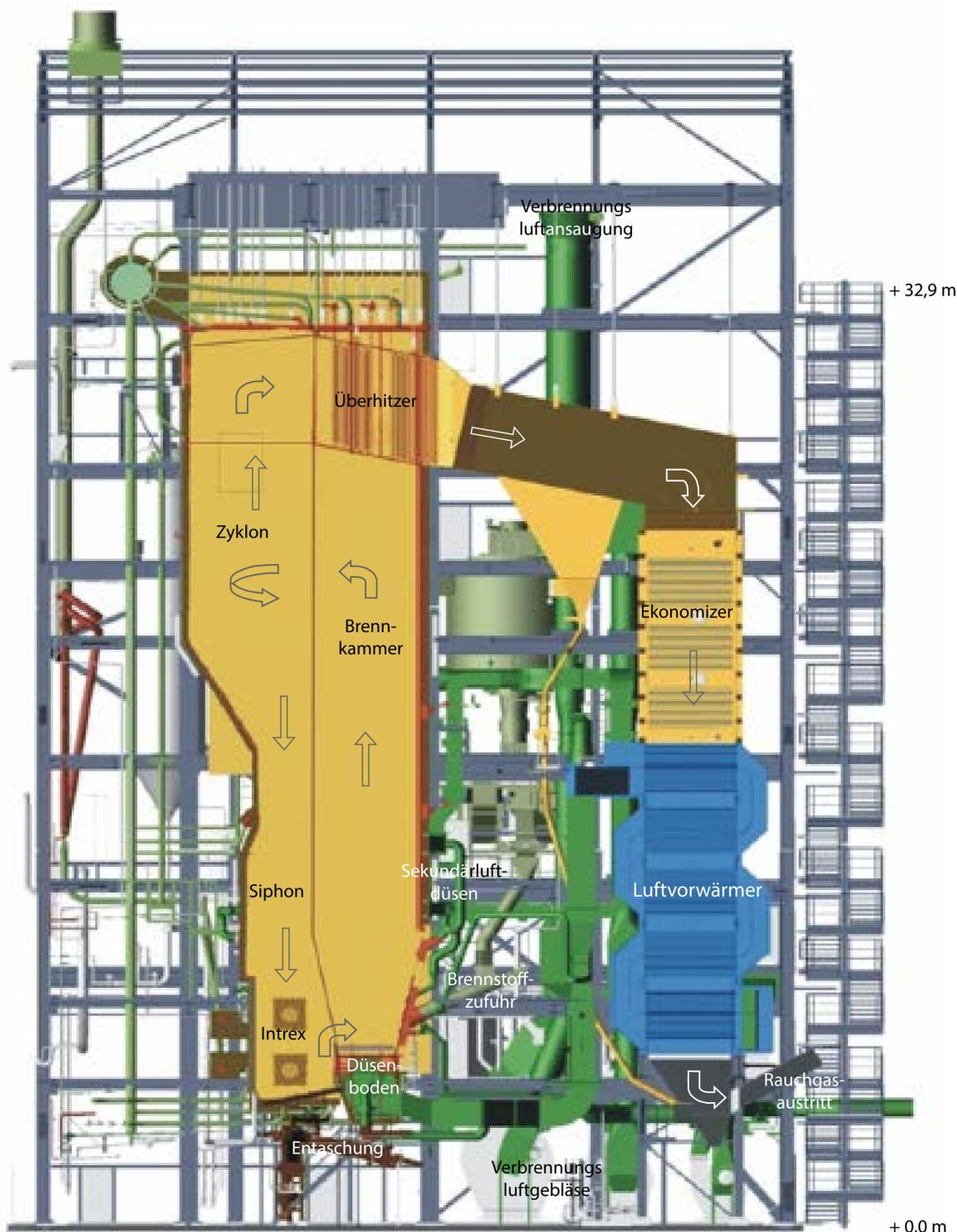
Der Kessel des Biomasseheizkraftwerks Emlichheim ist mit einer zirkulierenden Wirbelschichtfeuerung ausgerüstet. Diese schafft optimale Bedingungen zur schadstoffarmen Energieerzeugung aus Alt- und Gebrauchthölzern.
